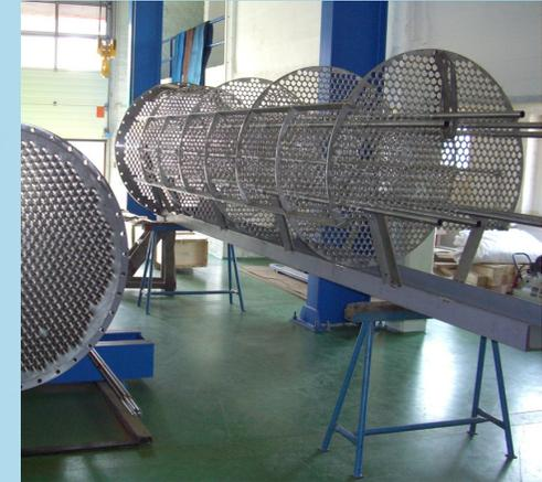
Vorbereitung der Montage der Zirkonium-Umlenbleche und des Zirkonium-Rohrbündels in das Zirkonium-Mantelrohr
