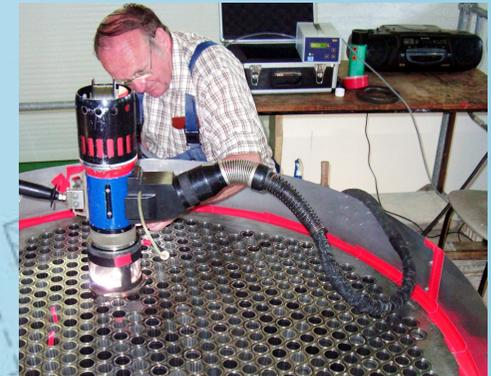
Einschweißen des Zirkonium-Rohrbündels ohne Anlauffarben
