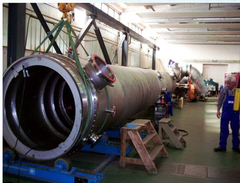
Schweißen und Montage von Zirkoniumkomponenten
