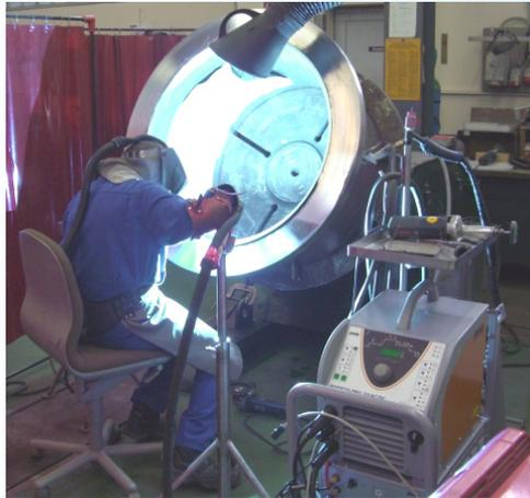
Schweißen von Komponenten aus Zirkonium mit Überwachung der Schutzgaszusammensetzung
