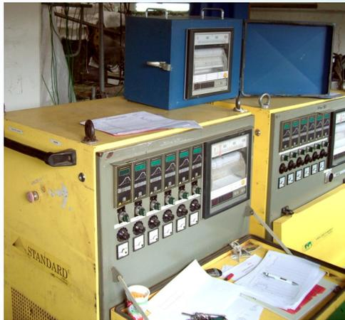
**Moderne Geräte- und Überwachungstechnik für die Wärmebehandlung der Rohreinschweißungen**
