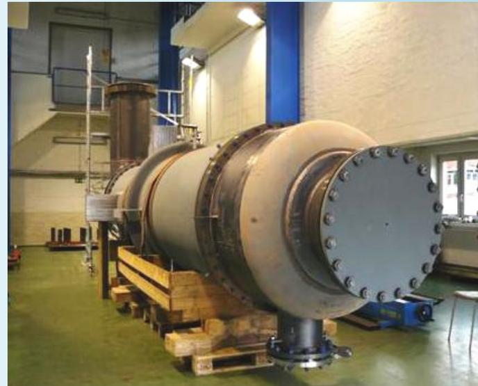
Zirkonium-Rohrbündel-Wärmeübertrager für die Linde AG
